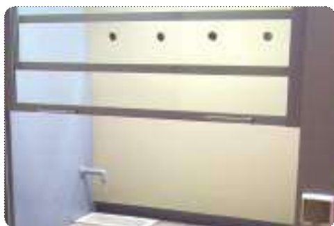
РАБОЧАЯ КАМЕРА ТЕФЛОН+ПОЛИПРОПИЛЕН
